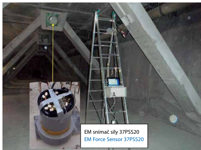
Obr. 12 Meranie sily pomocou snímača sily 37PSS20 na závese č. 2T pylónu č. 11 Fig. 12 Measurement of strand forces on cable stay No. 2T, pylon No. 11
