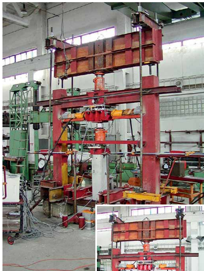
Obr. 1 Skúšobná zostava krátkych stĺpov (nezosilnený a zosilnený stĺp) Fig. 1 Test setup for short columns (non-strengthened and strengthened column)
