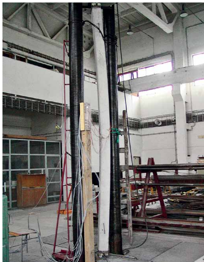
Obr. 2 Skúšobná zostava štíhlych stĺpov (nezosilnený a zosilnený stĺp)
