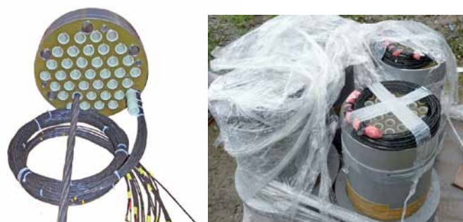
Obr. 2 Konštrukcia snímača 37PSS20 Fig. 2 EM sensor 37PSS20
