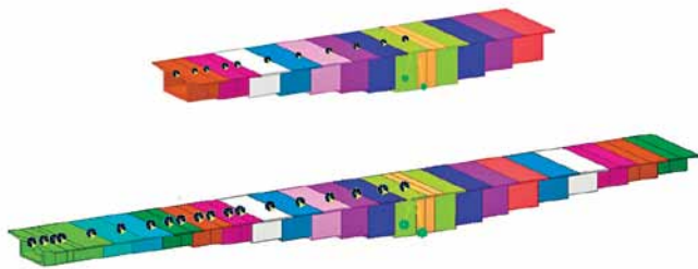
Obr. 8 Výpočtový model vahadla Fig. 8 Numerical phased model of the cantilever
