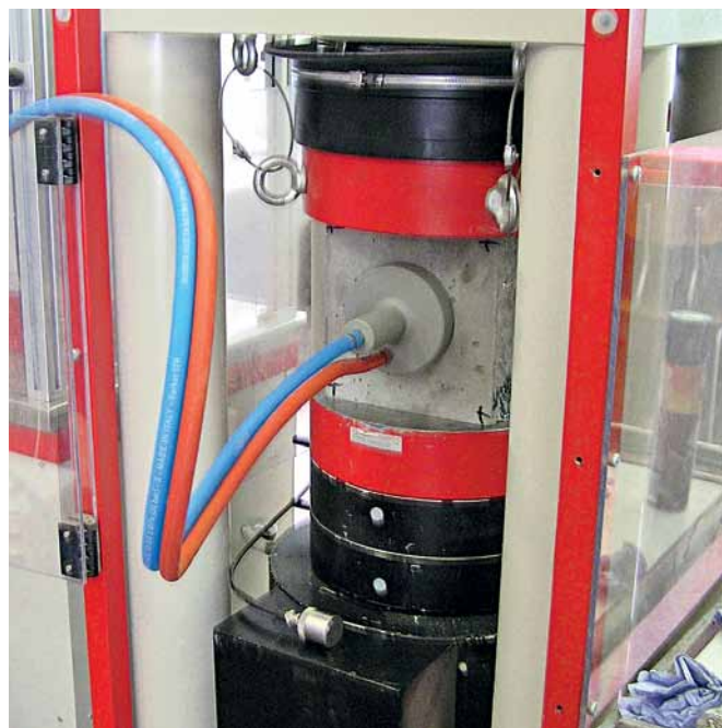
Obr. 4 Meranie vzduchopriepustnosti na betónových kockových vzorkách (skúška vzduchopriepustnosti na kockových vzorkách vystavených tlakovému namáhaniu) Fig. 4 Air permeability measurement on concrete cube specimens (air permeability test on cube specimens exposed to compressive load)
