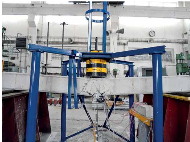
Obr. 3 Skúšobná zostava nosníkov zatažených nárazovým zatažením (nezosilnený a zosilnený nosník) Fig. 3 Test setup for beams under impact load (non-strengthened and strengthened beam)
