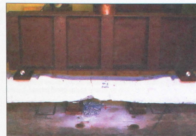
Obr. 4 Porušenia podvalov typickými ohybovými trhlinami pri dynamickom zaťažovaní.
