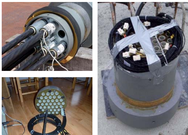
Obr. 3 Použitie jednonanových EM snímačov na meranie distribúcie sily medzi jednotlivé láná kábľa a ich náhrada multilanovým snímačom, ktorý je súčasťou kotvenia kábľa.
