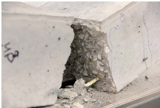
Obr. 1 Zaťažovacia zostava na stanovenie ohybovej odolnosti a porušený nosník (1. séria)
