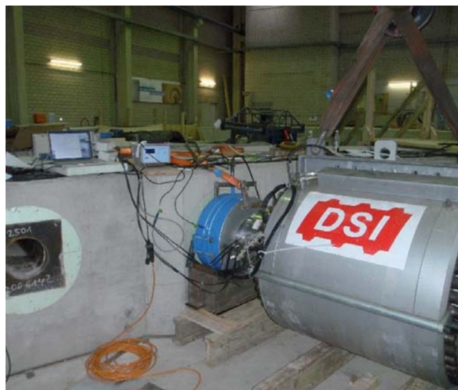
Obr. 4 Multilanový snímač pre 55 lán určený na zabudovanie do predpínacieho lisu PAUL TENSA. Snímač bol vyvinutý pre firmu DSI, Unterschleissheim, Nemecko.
