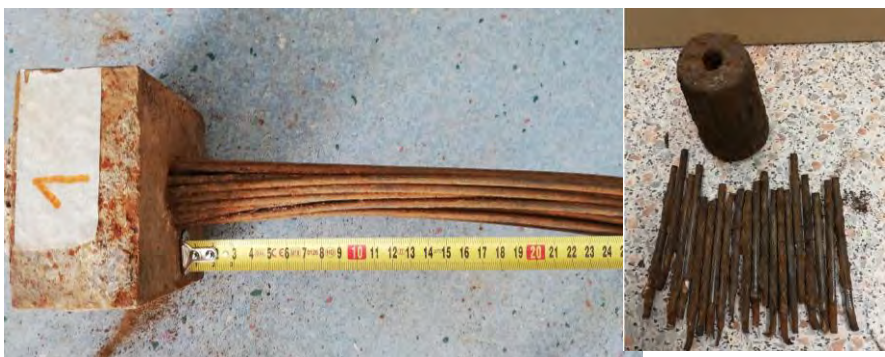
Obr. 2 Systém Horel – kotva 20 \phi P 4,5mm a kotevný kuželík s otvorom pre injektovanie (Most Spišská Nová Ves)
