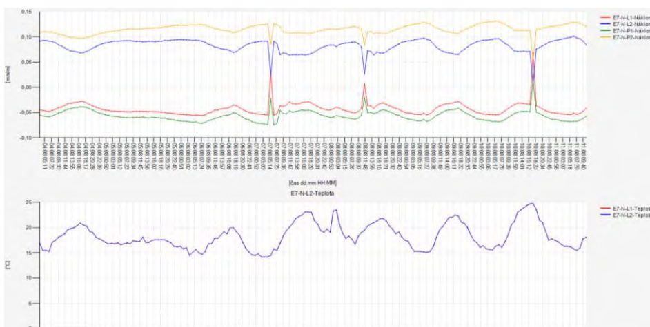
Obr. 8 Časový záznam merania pootočenia poľa a teploty v komore
