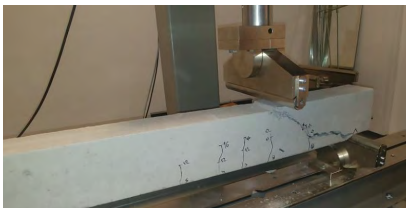
Obr. 3.1 Porušenie nosníka v šmyku
