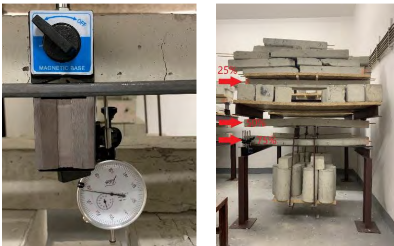
Obrázok 4: Zaťažovacia zostava- dlhodobé merania
