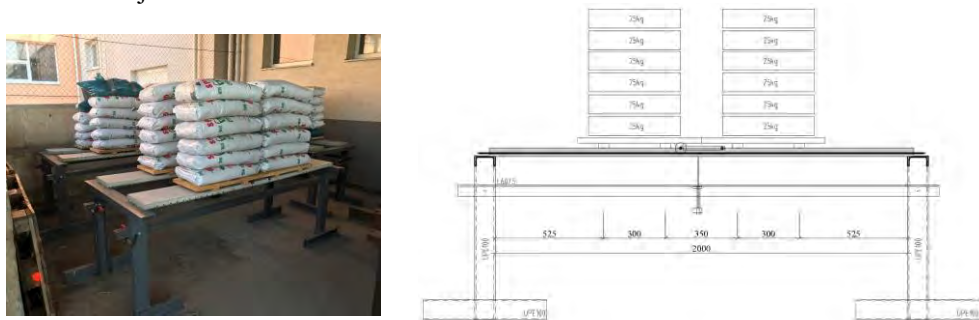
Obr. 6.1 Zaťažovacia zostava pre sledovanie dlhodobých vlastností GFRP výstuže
