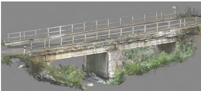
Obrázok 2: 3D axonometria scanu mosta mračnom bodov
