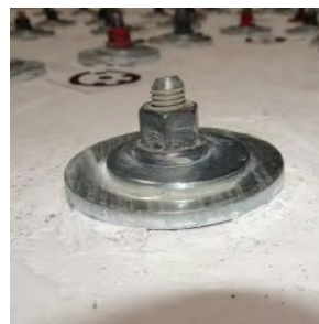
Obr. 2 Použitá šmyková výstuž
