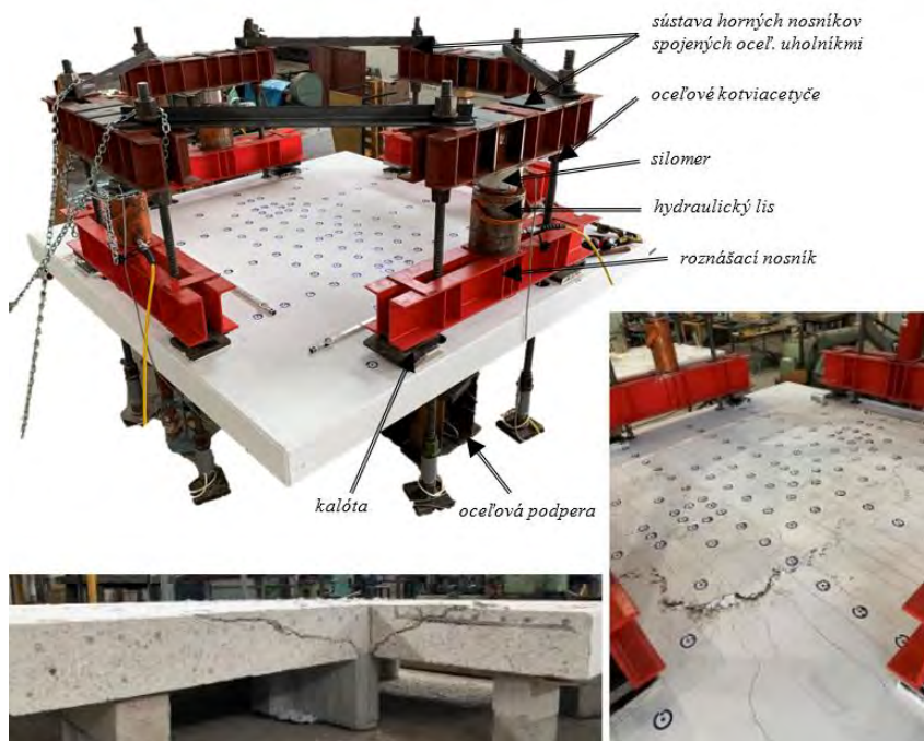
Obr.2.1 Skúšobná zostava, doska D03 (x/y) po porušení
