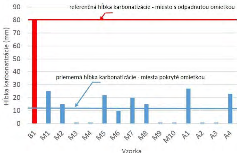
Obrázok 3 Hĺbka karbonizácie betónu pod ochrannou krycou omietkou a na odpadnutom mieste - most Sládkovičovo
