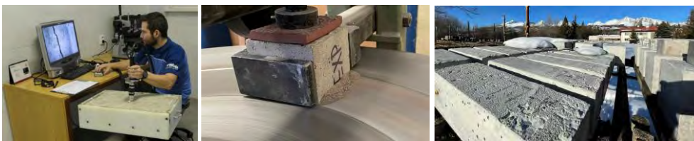
Obrázok 2 Skúšky v 2. etape - vznik trhlín, obrusnosť, dlhodobá expozícia
