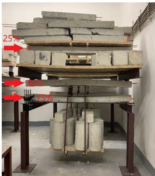
Obr. 5.1 Fotografia dlhobodej zaťažovacej zostavy (percento zaťaženia nosníkov vyznačené červenou farbou)
