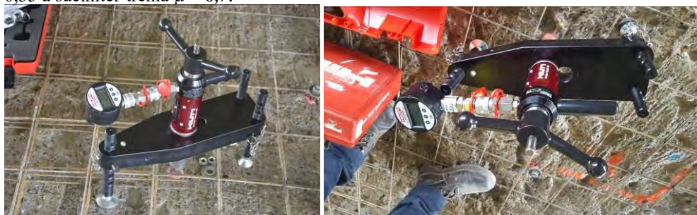
Obr.7 Ťahové skúšky spriahajúcich konektorov
